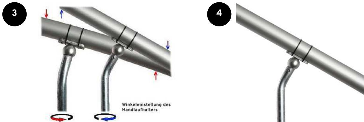
Une fois la verticalité contrôlée, visser les supports aux tiges de garde-corps à l'aide des vis à tête plate (12).
